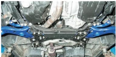
安裝完畢後必須電腦四輪定位校正
