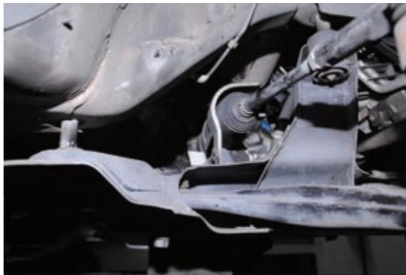
需拆卸前樑，因方向機固定螺絲方向不易拆卸，採用懸浮方式施工，將大樑卸放到可以取出防傾桿即可約5~7cm 距離，以不拉扯到方向機十字接頭及油管為注意部分
