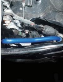
防傾桿可直接以穿繞方式更換,安裝時須注意防傾 桿方向兩末端部分朝上方
